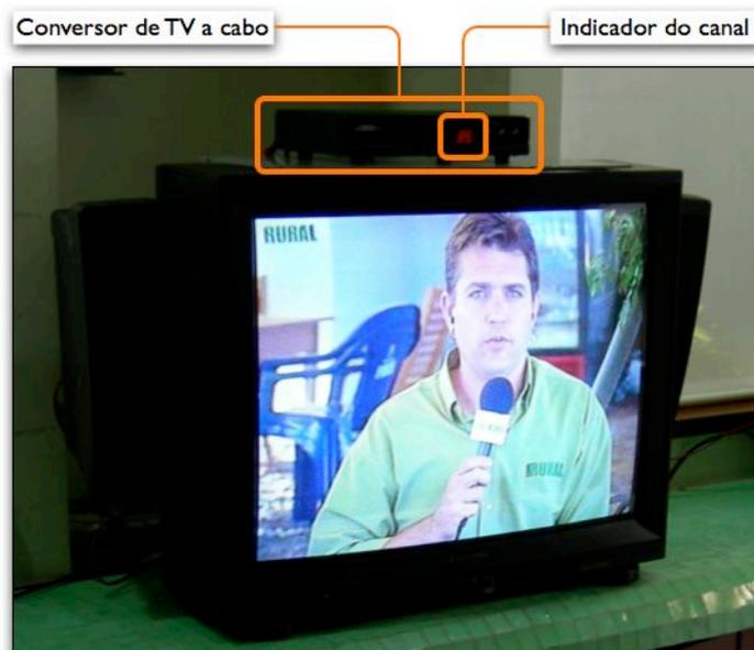
Figura 4-24 - Terminal de acesso da plataforma TV a cabo analógica
